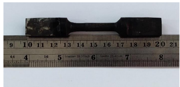
Gambar 5 Spesimen uji fatik standard JIS Z 2273 . 2.4 Pengujian Struktur Mikro
