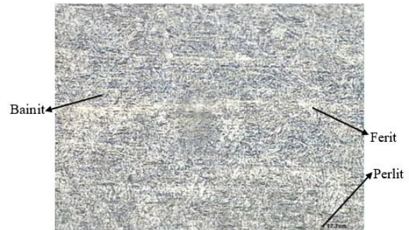
Gambar 13 Baja ASSAB 709 M Setelah Proses Austempering waktu tahan 15 menit Pembesaran 500X
