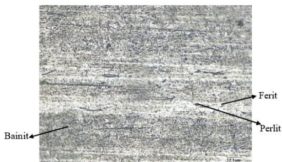
Gambar 12 Baja ASSAB 709 M Setelah Proses Austempering waktu tahan 10 menit Pembesaran 500X
