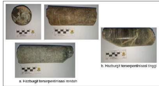
Gambar 12. Kenampakan megaskopis batuan dasar pada blok X (a) Hazburgit terserpentinisasi rendah (b) Hazburgit terserpentinisasi tinggi
