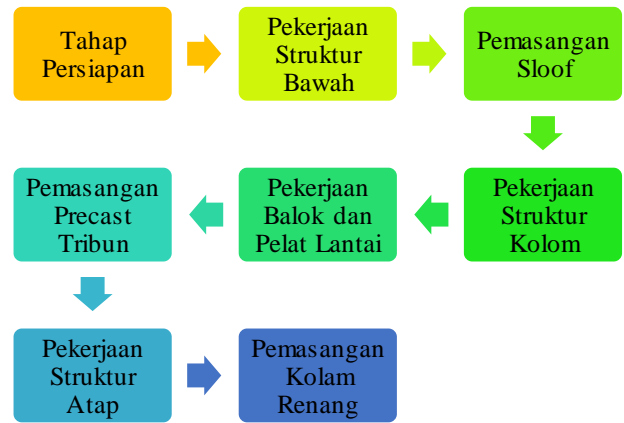
Gambar 1. Alur pekerjaan stadion akuatik
