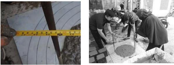
Gambar 3. Perhitungan slump untuk beton geopolimer
