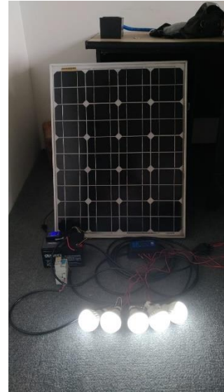
Gambar 7 Rangkaian PLTS saat beban dihidupkan
