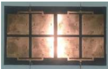
Gambar 6 Rancangan antena MIMO array tipe 4x4.
