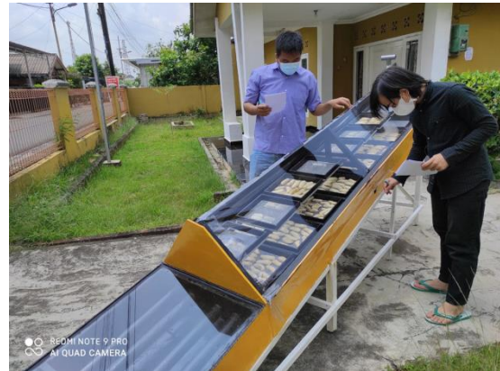
Gambar 6. Proses Pengeringan Menggunakan Alat Pengering Tenaga Surya.
