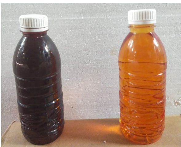
Gambar 3. Limbah awal (kiri) dan hasil pengolahan menggunakan alat elektrokoagulasi dan filtrasi (kanan)
