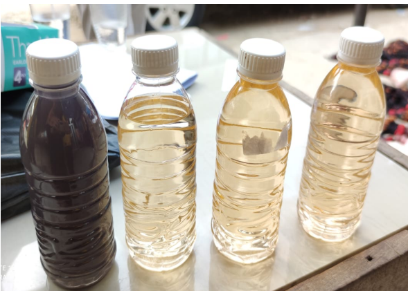
Gambar 2. Limbah awal (paling kiri) dan hasil pengolahan menggunakan alat elektrokoagulasi dan filtrasi (3 sampel setelahnya)
