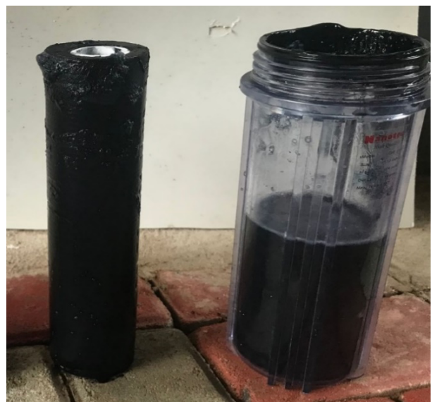
Gambar 4. Kondisi nano filter pertama setelah proses pengolahan limbah cair kain jumptan
