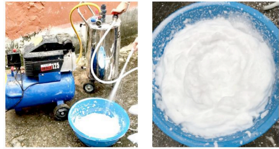
Gambar 5. Proses produksi foam
