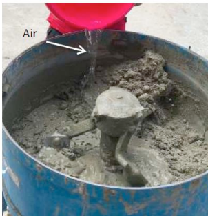
Gambar 4. Pencampuran material kering dengan air
