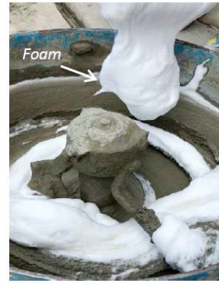
Gambar 6. Proses pencampuran foam dalam mortar
