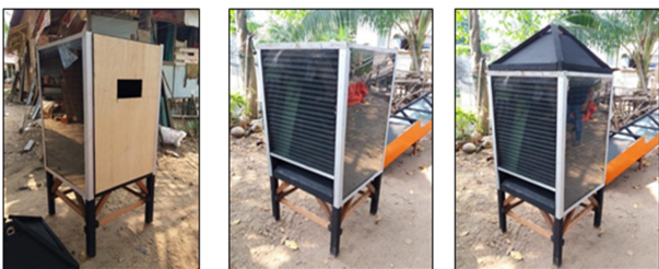
Gambar 5. Pemasangan Kaca pada Ruang Pengering
