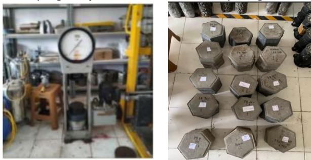
Gambar 11. Pengujian Kuat Tekan
