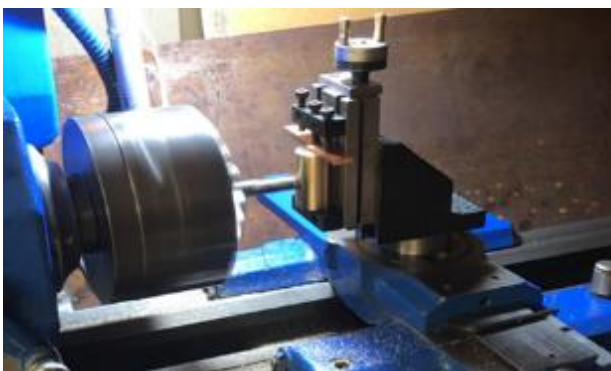
Gambar 5 Pemanfaatan mesin bubut untuk pemesinan lain.
