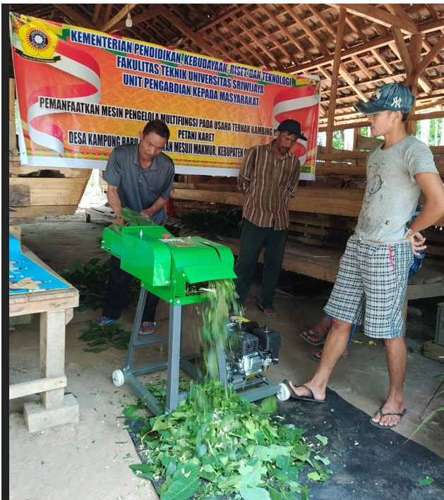
Gambar 6. Ujicoba mesin pencacah pakan ternak untuk mencacah rerumputan
