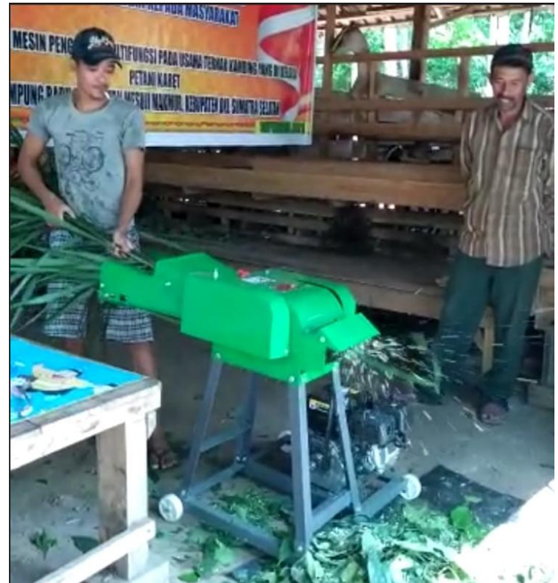
Gambar 7. Ujicoba mesin pencacah pakan ternak untuk mencacah dahan kelapa sawit
