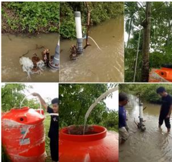
Gambar 10 Debit yang dihasilkan Pompa Vachydram
