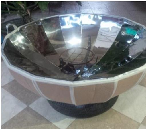
Gambar 2. Prototipe Kompor Sury Sederhana Tipe Setengah Bola
