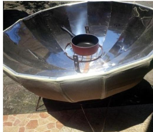
Gambar 3 Prototipe Kompor Surya Sederhana tipe parabolik
