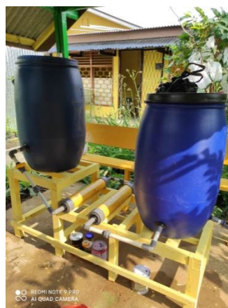
Gambar 2. Rancangan Instalasi Penjernih Air
