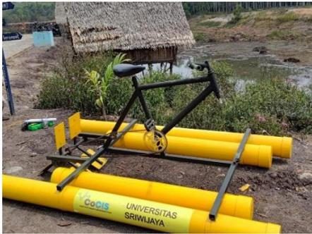
Gambar 4 Hasil Perancangan Sepeda Air
