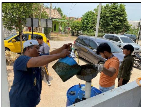
Gambar. 23. Feed Dimasukkan ke Dalam Digester
