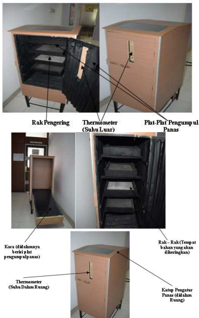
Gambar 2. Alat Pengering Buatan Jurusan Teknik Pertambangan
