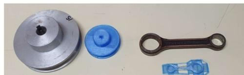
Gambar 5. Perbandingan contoh benda dan hasil *rapid prototyping*
