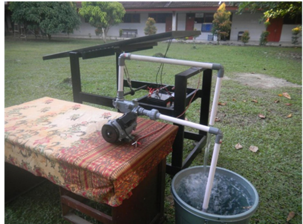
Gambar 4. Pengujian sistem pompa air bertenaga surya
