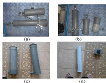
Gambar.2. Pengembangan produk prototipe peralatan teknologi penjernihan air (berbagai ukuran sesuai kebutuhan) dengan alat filter dan carbon active dengan variabel ukuran 0,3 \mu\text{m} dan 0,5 \mu\text{m} .
