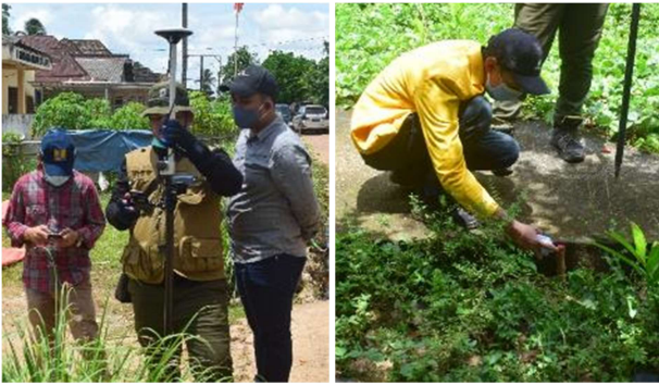
Gambar 18. Proses pengukuran lahan masyarakat dan pemasangan patok
