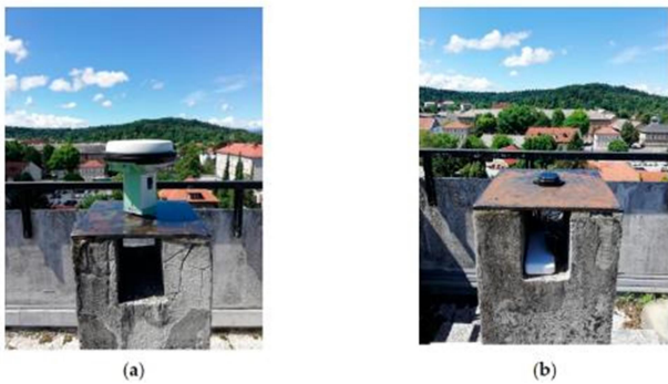
Gambar 4. GPS Geodetik Leica (a) dan GNSS-RTK ZED-F9P (b)
